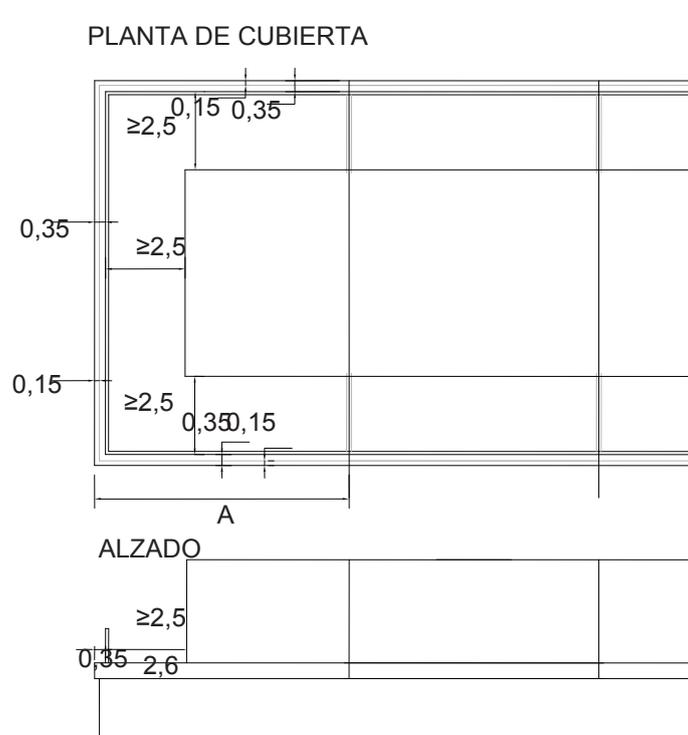
Fig.1. Formación de Cubierta-Terraza, planta-alzado
