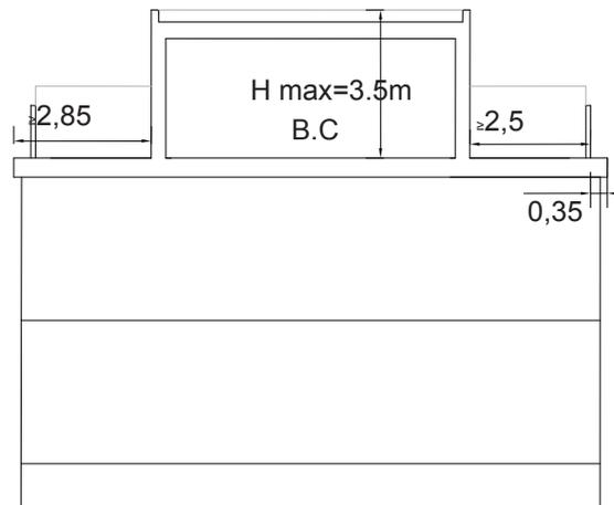
Fig.2. Formación de Cubierta-Terraza, sección
